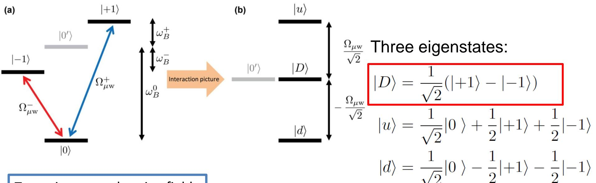
$$H_{\mu w}^I = \frac{\hbar\Omega_{\mu w}}{2}(|+1\rangle\langle 0| + |-1\rangle\langle 0| + h.c)$$
